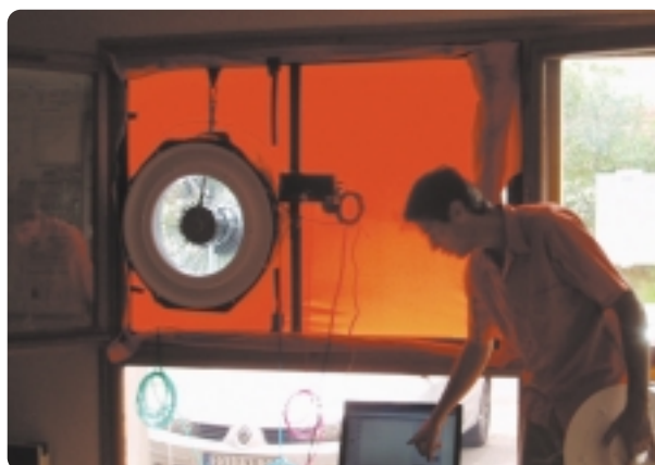
Mesure de la perméabilité à l'air d'un bâtiment par le principe de la porte soufflante («blower door»)
